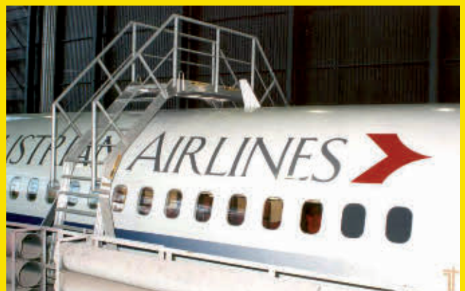
Flugzeugwartungsanlage mit Überstieg
